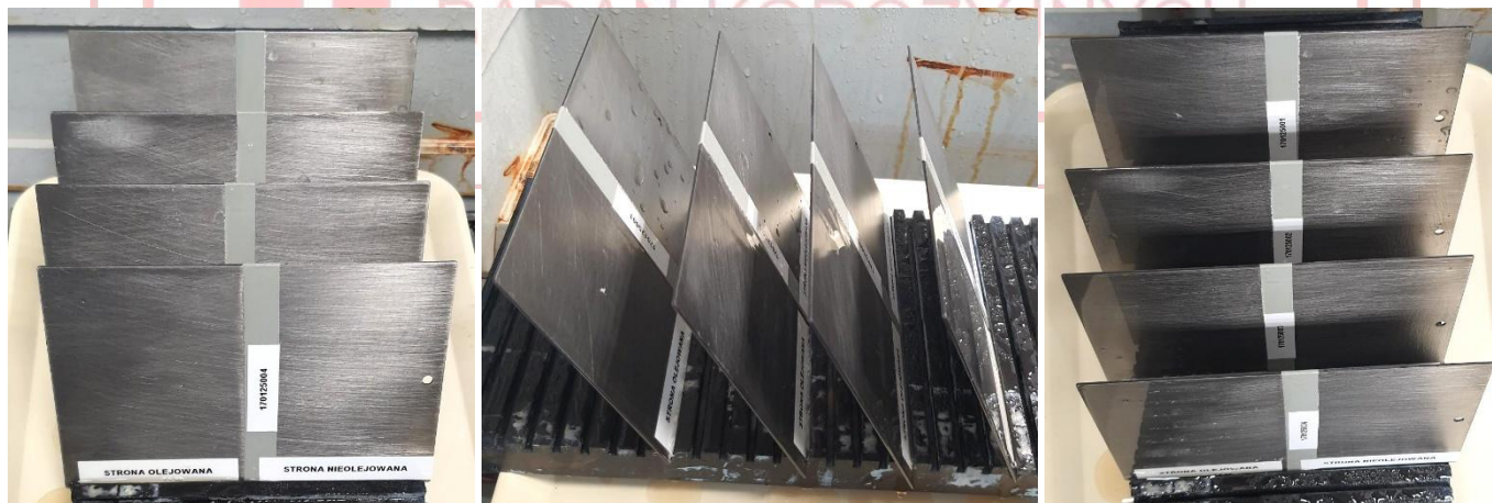
Ułożenie próbek w komorze podczas badania
