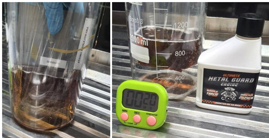
Procedura olejowania metodą zanurzeniową
